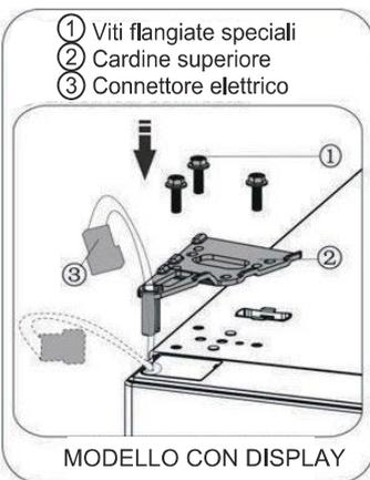
16. Collegare il connettore elettrico ① come mostrato in figura, quindi fissare la parte ② con la vite ③ fare riferimento al passaggio 2.
