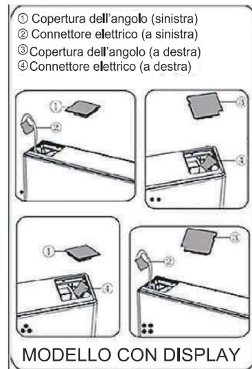
7. Allentare la vite ③ e rimuovere la parte ② e la parte ①. Installare il fermo dello sportello di sinistra-sinistra ④ fornito (nel sacchetto di plastica) e la parte ② (blocco di arresto) sul lato sinistro con la vite ③. Mantenere il componente ① nell'apparecchio per utilizzi futuri.
